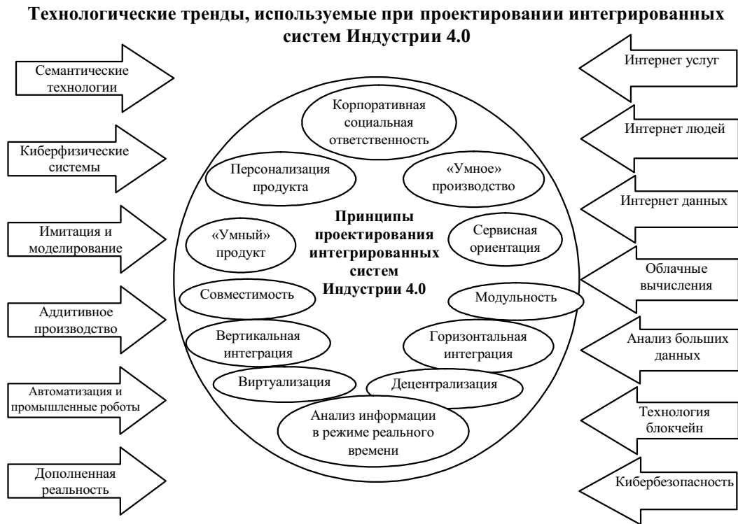
Рис. 1. Технологические тренды и принципы проектирования интегрированных систем Индустрии 4.0
